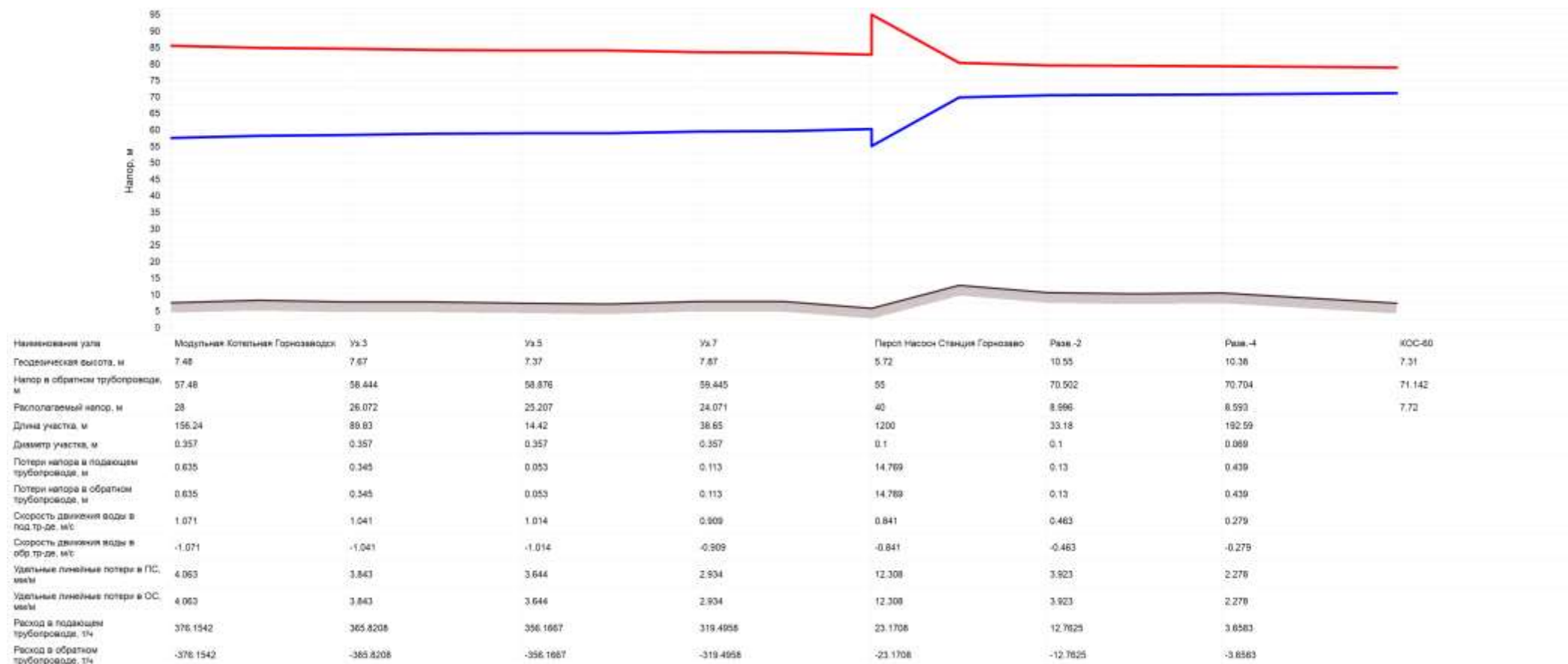
Рисунок 18 Пьезометрический график от модульной котельной до потребителя КОС (при переключении нагрузки с котельной №12)
