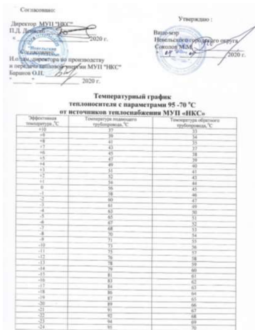
Рисунок 20 Температурный график теплоносителя от источников теплоснабжения МУП «НКС»
