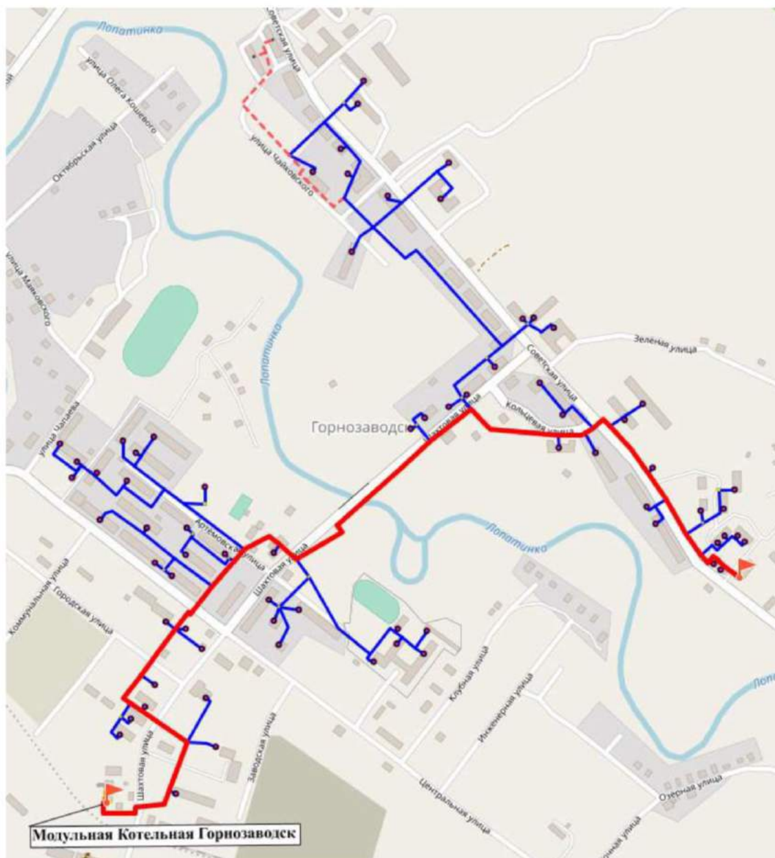
Рисунок 32 - Путь построения пьезометрического графика от модульной котельной до потребителя Советская, 59
