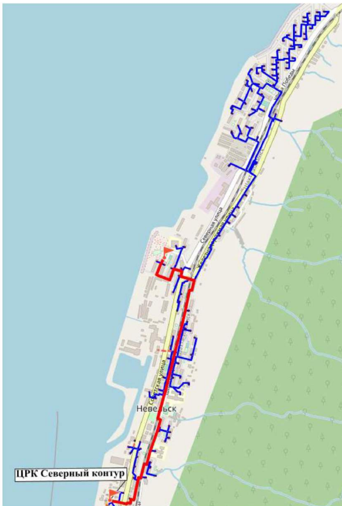
Рисунок 26 - Путь построения пьезометрического графика от Центральной районной котельной до потребителя 70 лет Октября,5
